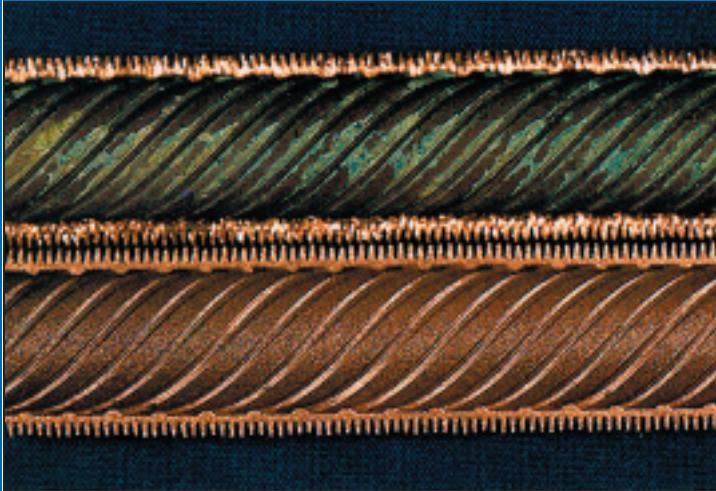
管道的剖面视图，上面的是原先使用状态，下面的是安装旁路固液分离装置后的状态。
